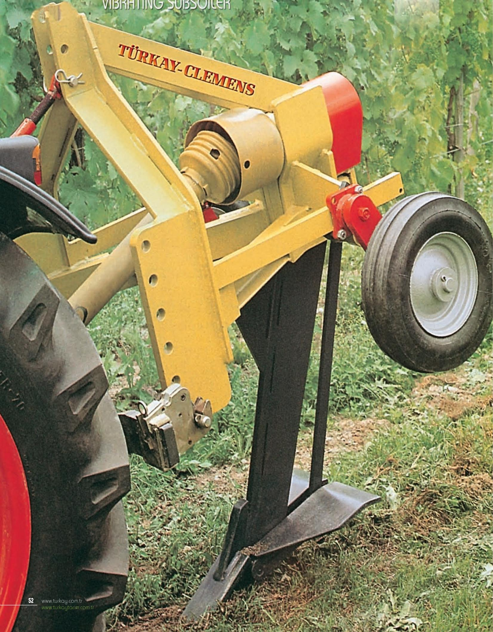
Meyve bahçeleri, bağlar ve tarlalarda mekanizasyonun artmasıyla toprağın sıkışması, yapısının bozulması problemi de büyür. Taban taşı oluşumuna karşı en etkili savaş yöntemini kullanan Türkay titreşimli dipkazan ile;
