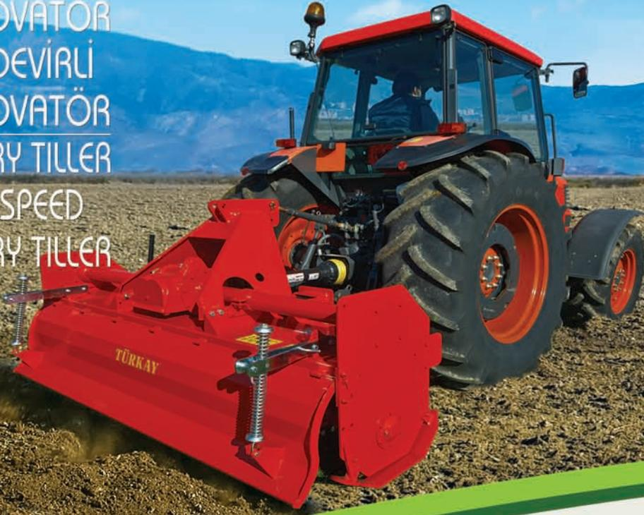
Türkay Sabit Rotovatör, özellikle tarla, bağ ve bahçelerde, tohum yatağı hazırlama, anız bozma işlemlerinde kullanılan ikincil toprak işleme makinası olup; ayrıca bitki artıkları ve organik gübreyi toprağa karıştırarak, toprakta humus artışına yardım eden ve yabancı otları mekanik olarak yok ederek kimyasal ot mücadelesine gerek bırakmayan çevre dostu, çok yönlü ve uzun ömürlü bir makinadır.
