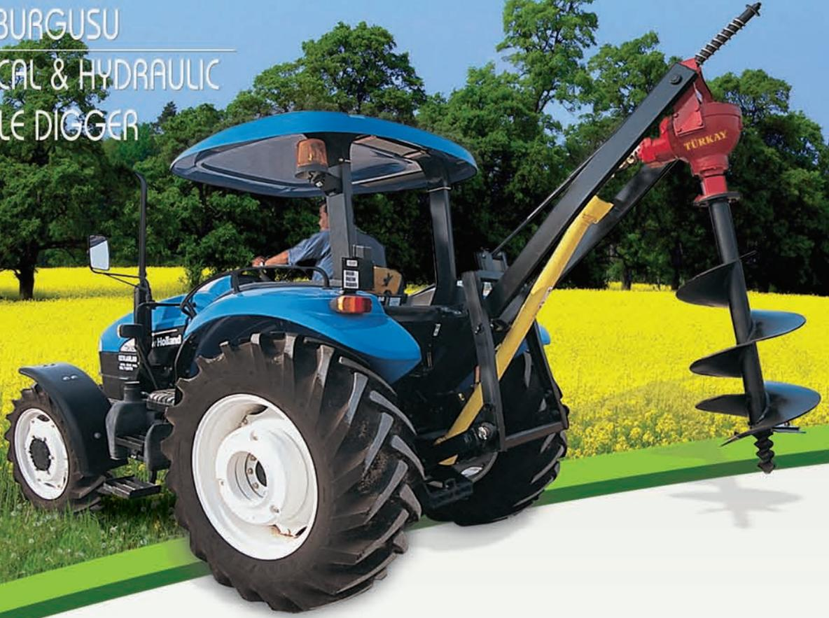
Ağaç fidanlarının dikiminde, zeytin, meyve, fındık fidanları dikiminde ve çit direkleri montajında doğru matkap seçildiğinde ideal bir makinadır. Toprak burgusu traktöre üç nokta askı düzeni ile kolayca bağlanarak, kuyruk milinden tahrik olarak çalışır. Hidrolik pistonlu modeli ile sert ve taşlık zeminlerde dahi kolayca derine inmesi sağlanmıştır.
